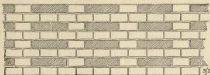
Rys. 13. Wiązanie cegieł holenderskie, w Anglii samandkient zwane, składające się z warstwy wiązania polskiego i z warstwy głuszkowej.
